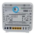
Schmaler Glasfaserkabel-Stecker (Schutzkappe entfernen) mit der Glasfasersteckdose verbinden (Steckplatz 1)
